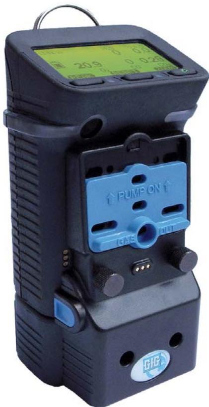
distance. En mode de pompage, les orifices de diffusion sont masqués et les résultats de mesure ne sont pas influencés par les courants atmosphériques. Un système filtrant protège la pompe et les capteurs de la poussière et de l'humidité. En mode d'arrêt de la pompe, le détecteur de gaz est exploité comme d'habitude via les orifices libres de diffusion.
