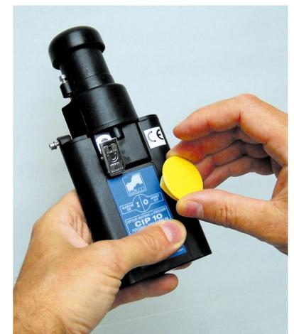
Le **CIP 10 M** peut fonctionner dans toutes les positions. En effet, la solution de collecte est plaquée par effet centrifuge sur les parois internes de la coupelle en rotation. Cependant, avant le démarrage, le **CIP 10 M** doit être maintenu en position verticale pour éviter tout rejet du fluide.
