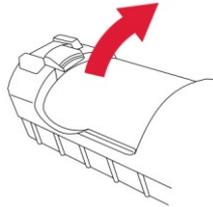
4. Remplacez une batterie de rechange entièrement chargée dans le compartiment. Assurez-vous d'orienter correctement la batterie dans son compartiment.
