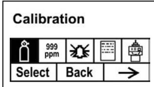
Pour sélectionner l'étalonnage du zéro ou l'étalonnage de la mesure, appuyez sur [N/+]. Une fois l'étalonnage de votre choix en surbrillance, appuyez sur [Y/+].
