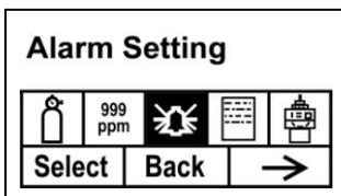
1. Parcourez le menu Alarm Setting à l'aide de la touche [N/-] jusqu'à ce que vous atteignez le seuil d'alarme à modifier (High Alarm, Low Alarm, STEL Alarm et TWA Alarm)
