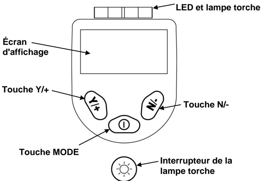
Outre les fonctions indiquées par l'intitulé même des touches, les touches Y/+, MODE et N/- sont des touches programmables permettant de contrôler plusieurs paramètres et de sélectionner des options dans les menus du détecteur. Chaque touche permet ainsi, d'un menu à l'autre, de contrôler un paramètre différent ou de sélectionner une autre option.
