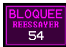
Au bout d'une minute, la pompe tentera de redémarrer. Si la pompe n'a pas pu redémarrer après le nombre spécifié de tentatives, la pompe va mettre fin à la séquence d'échantillonnage en cours et afficher un message d'erreur.
