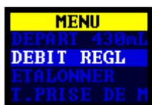
Il s'agit du menu que vous utilisez régulièrement pour la réinitialisation, le réglage du débit et l'étalonnage de la pompe entre les échantillonnages. Ceci vous donne également accès à la commande de minuterie (voir *Configuration avant de démarrer un échantillonnage* à la page 14 et *Programmes de minuteur (modèles Pro uniquement)* à la page 17).
