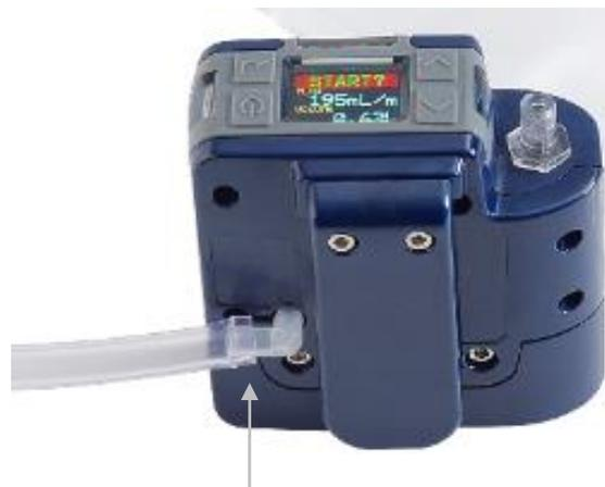
Lorsque la pompe est utilisée pour collecter du gaz, raccordez le tube de ballon à gaz à la sortie de la pompe en utilisant le raccord Luer fourni.
