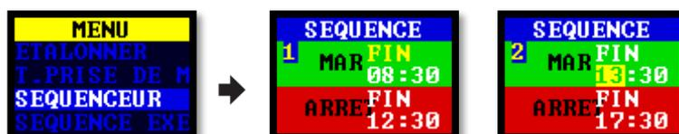
Une séquence dure jusqu'à ce qu'une période OFF ait été réglée sur END (fin). Dans l'exemple ci-dessus, la pompe fonctionne le matin et l'après-midi avec une heure d'arrêt pendant le déjeuner du porteur.
